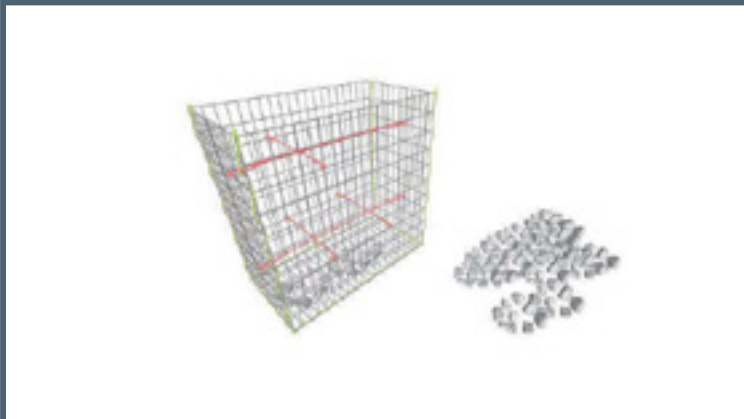
7 – Remplissage du gabion
