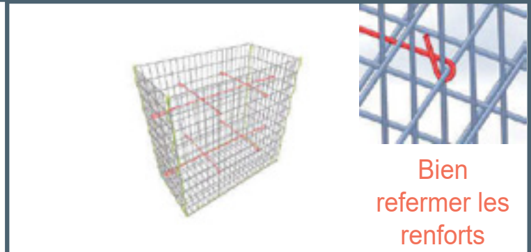
8 – Assemblage du couvercle - Fermeture du gabion
