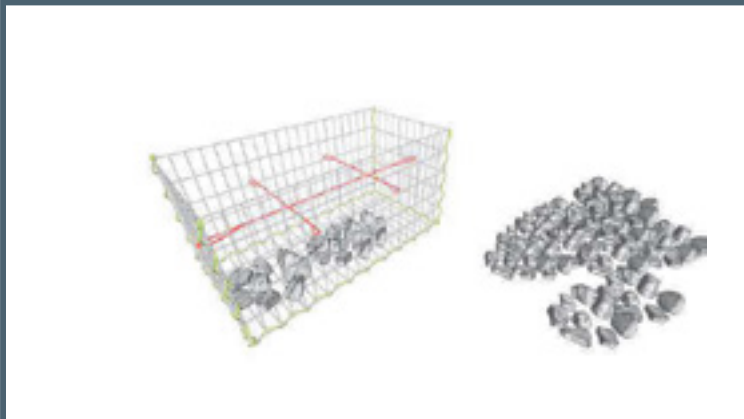
7 – Remplissage du gabion
