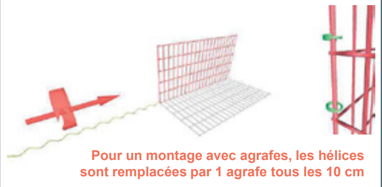
4 – Assemblage du 2 nd côté
