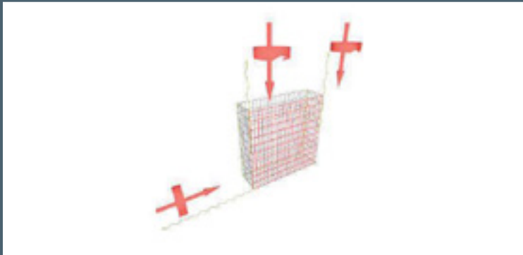
7 – Remplissage du gabion
