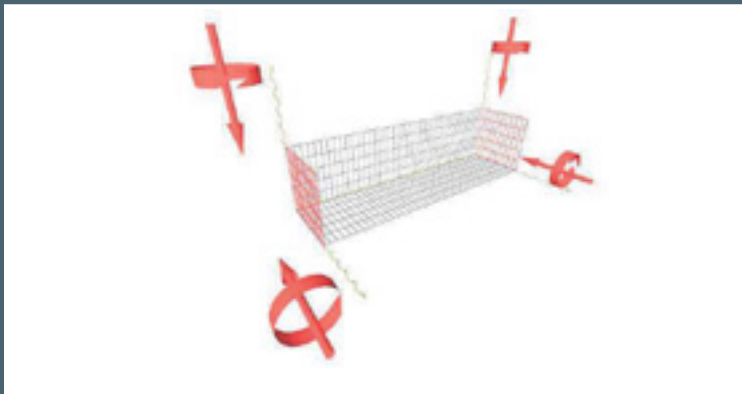
5 – Assemblage du diaphragme
